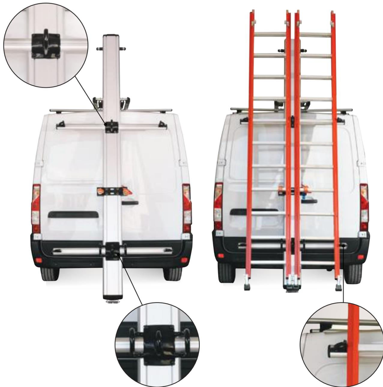
Due archi regolabili, rivestiti da una speciale guaina protettiva, permettono l'alloggiamento di due scale, una affianco all'altra. Un piatto in acciaio con due cinghie assicurano le scale durante la marcia del veicolo.
