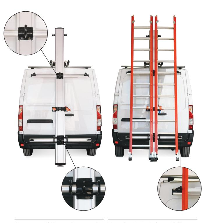
Deux arceaux réglables, revetûs par une gaine protectrice, permettent le logement de deux échelles l'une à côté de l'autre. Un plateau en acier avec deux sangles garantissent la stabilité des échelles pendant la conduite.
