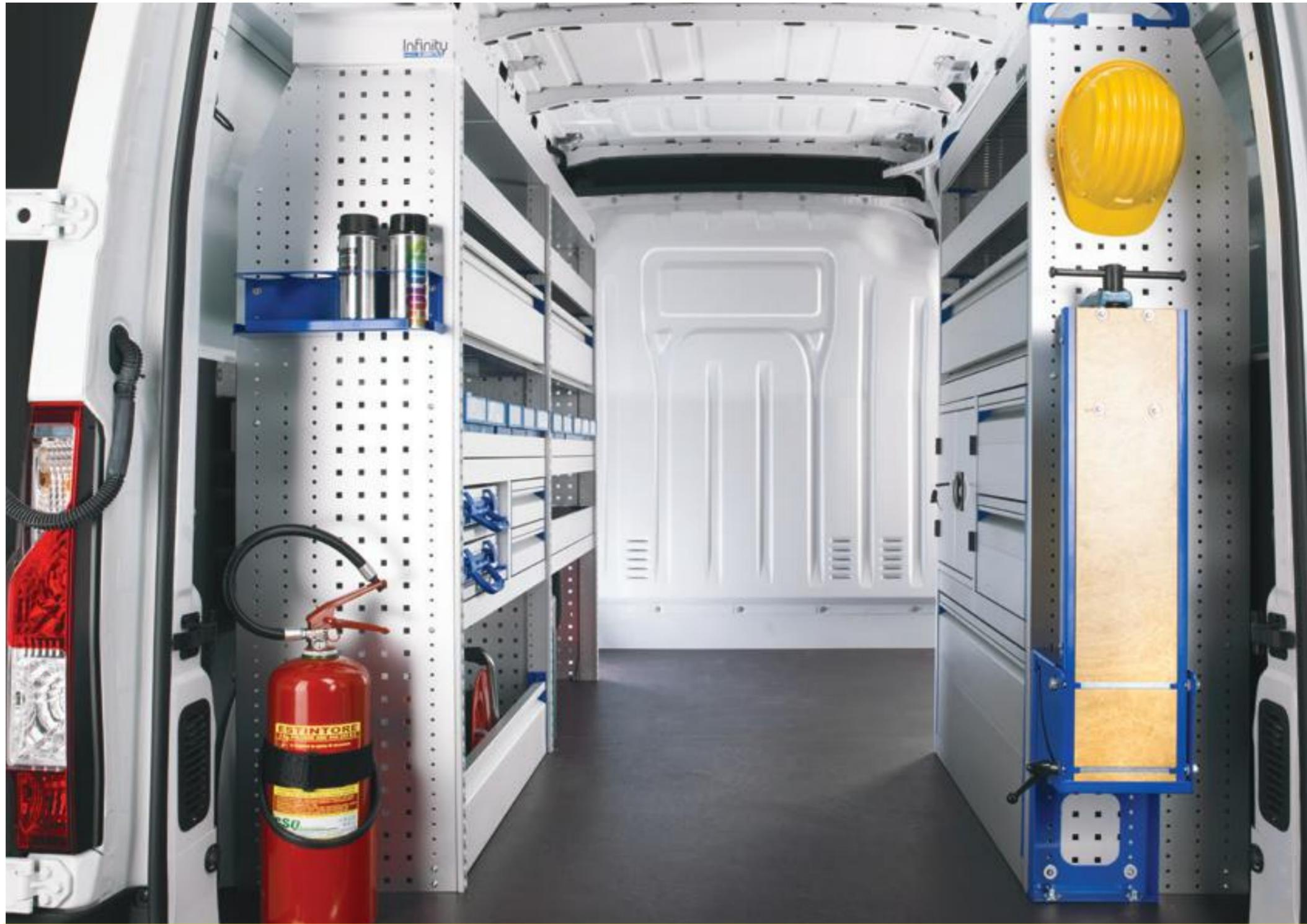
**INFINITY** ist die revolutionelle Fahrzeugeinrichtung bestehend aus Aluminium Profilen, ein innovatives und stark technologisches Produkt aufgrund seiner vielseitigen Einsatzmöglichkeiten. Eloxiertes Aluminium verleiht der Fahrzeugeinrichtung Langlebigkeit und Schutz gegen Korrosion.
